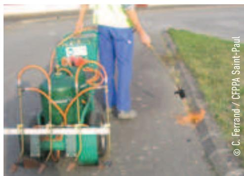
Une flamme issue de la combustion d'un gaz, appliquée à plus de 1000°C sur la végétation permet de la détruire. Le stade idéal pour intervenir est de 2 à 3 feuilles. Si les plantes sont plus développées, il faudra augmenter le temps d'application au niveau du collet des plantes.
