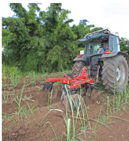
Désherbage mécanique avec des disques en X
