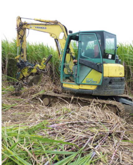
Coupeuse péi (canne longue), mono-lame, située à Saint-Benoît, Est de La Réunion
